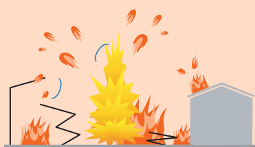
Leichte Blechkonstruktionen bieten Explosionen kaum Widerstand. Druckwellen und brennende Teile können sich ungehindert ausbreiten.
