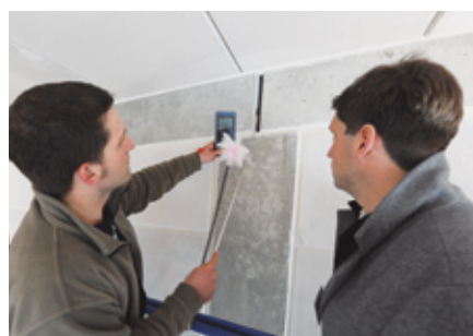
Aufspüren von Leckagen mit Federstab und Thermoanemometer
