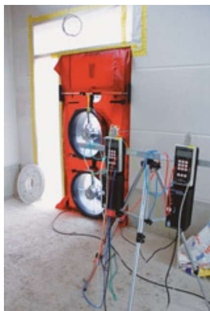
Versuchsaufbau mit BlowerDoor-Messsystem
